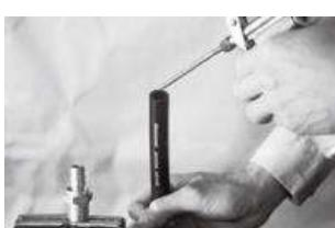
Potonglah selang tegak lurus dengan sumbu sebelum tabung pemotong. Masukkan selang air atau busa sabun ke dalam dan masukkan bagian Kopling.
